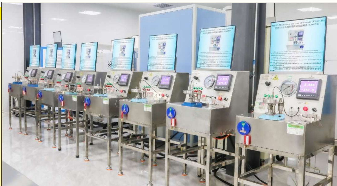
Комплект автоматического оборудования для механического испытания диастатов на долговечность. Каждое оборудование оснащено регистратором параметров испытания и количества циклов. (Лаборатория Ultimheat).
